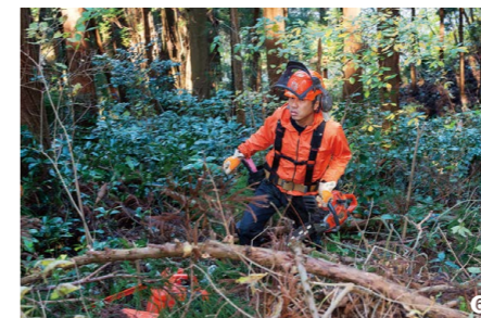
④P13から続く、雪洋平さんの伐倒作業。受け口の位置や角度を考えてチェーンソーで切り込みを入れる ⑤⑥傾斜のある現場なので足場を安定させながら慎重に作業を行う
